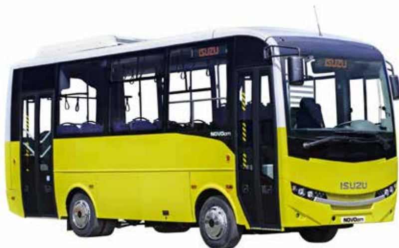
Varianta ISUZU Novo má i své odvozené městské provedení nazvané jednoduše jako Novo Citi. Vůz má plnit základní požadavky na přepravu cestujících. V zadní části vozu je podlaha snížena, takže lze přepravovat i vozíčkáře. © ISUZU
