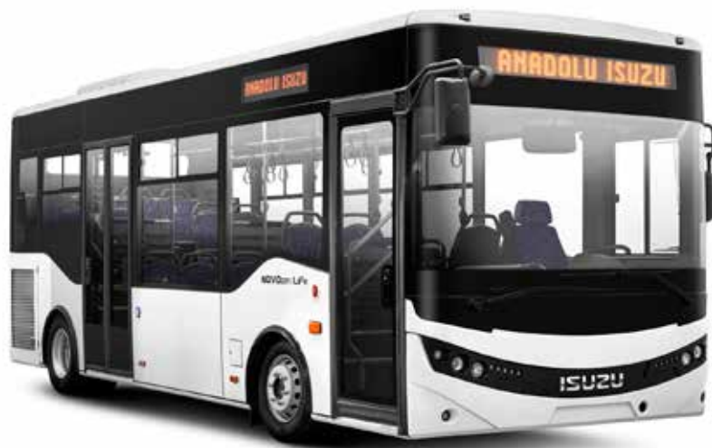
Nejnovější verze s názvem Novociti Life je rovněž částečně nízkopodlažní, koncepčně se ale zásadně odlišuje, neboť jde o klasický LE vůz s vyvýšenou podlahou jen nad zadní nápravou. © ISUZU
