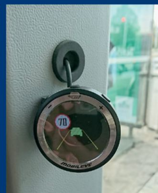
Na displeji se zobrazují informace z kamery na čelním skle
